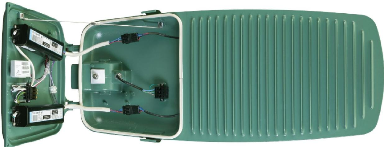
El recinto porta-equipos, es independiente del recinto óptico donde se encuentran los módulos LED, hermético, evitando que los mismos reciban emisión de calor de las fuentes de alimentación, logrando una más eficiente disipación generada en los módulos LED.
